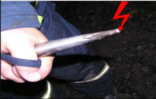
Blitzanschlagpunkt an ESE-Fangstange
